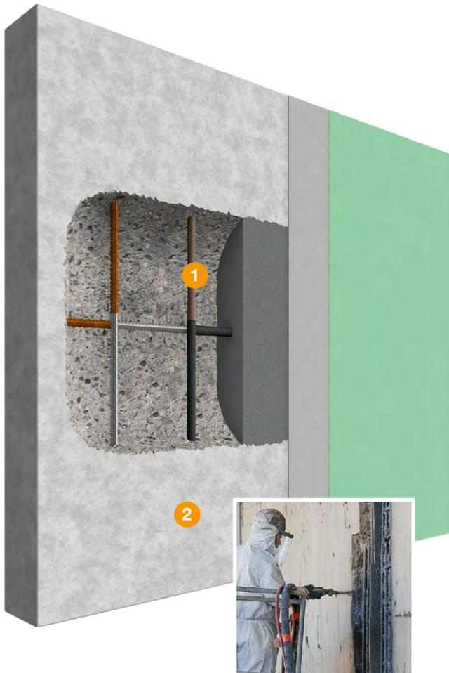
MasterEmaco SPCC-System wird zur Instandsetzung statisch relevanter Bauteile eingesetzt. Das System wird im Nassspritzverfahren in Schichtstärken von 8–50 mm aufgetragen und entspricht den Anforderungen nach ZTV-ING, Teil 3, Abschnitt 4 und der Beanspruchbarkeitsklasse M3 nach Rili SIB der DAfStb-Richtlinie.
