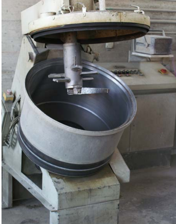
Abbildung 1: Für die Betonherstellung verwendeter Eirichmischer (maximales Fassungsvermögen: 80 Liter).
