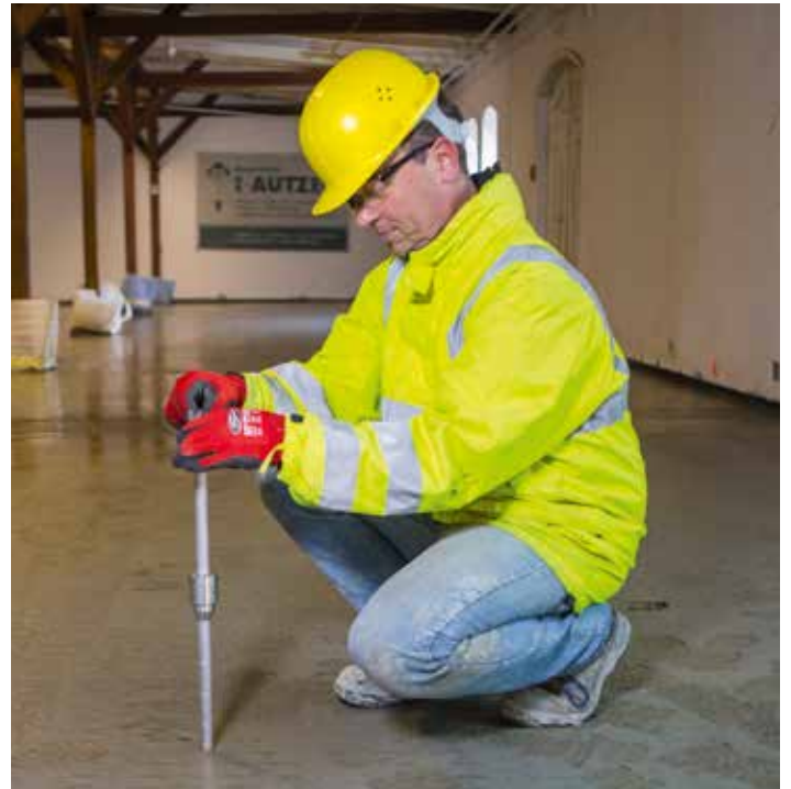
Die HUMM-Sonde ermittelt zuverlässig den richtigen Zeitpunkt für die Betonnachbearbeitung.
