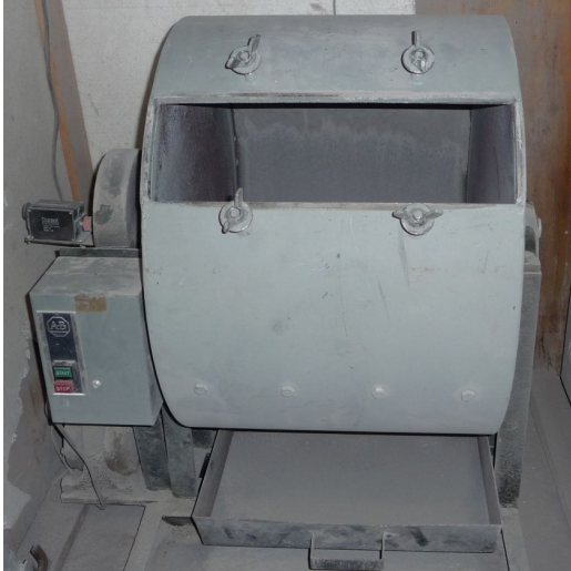
Prüfmaschine des Los Angeles Rattler-Tests
