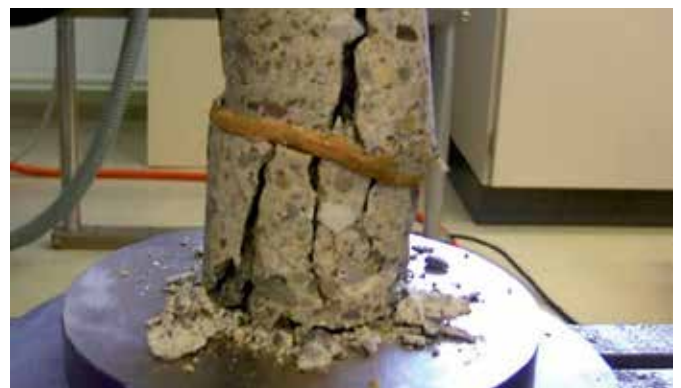
Revestimiento monolítico: puenteo de fisuras
