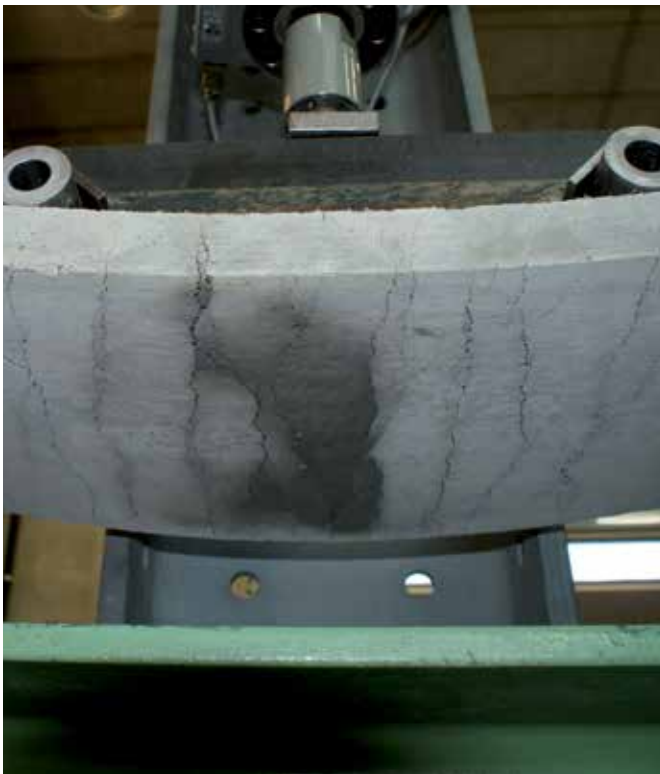
MasterFiber-kuidulla vahvistetun rakenteen monihalkeilukäyttäytymistä
