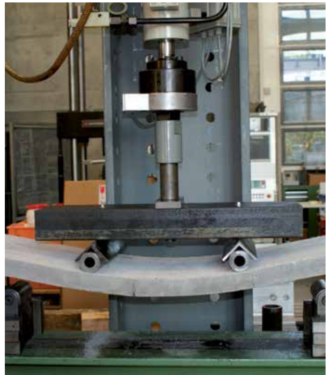
4-pisteen taivutusvetolujuustestausta LMC:n laboratoriossa
