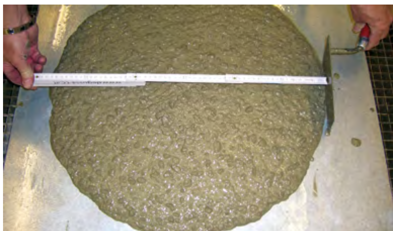
Badanie jakości betonu natryskowego
