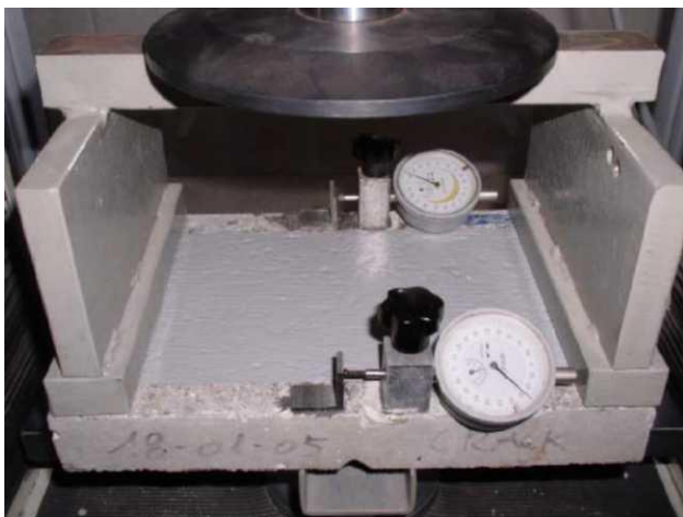
Statyczne badanie zdolności do mostkowania rys zgodne z normą EN 1062-7 (metoda A)
