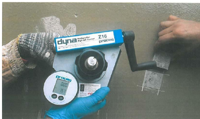
Определение прочности сцепления MasterSeal 7000 CR с поверхностью бетона
