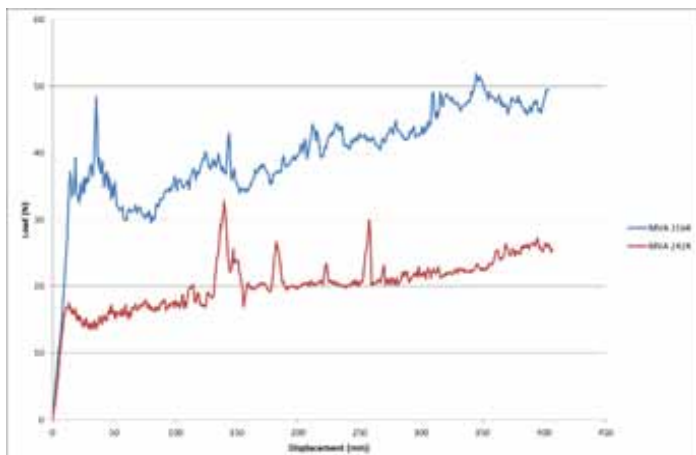
Graf 1: Závislost odporu betonové směsi na její viskozitě (obě betonové směsi se lišily pouze druhem superplastifikační přísady. Konzistence obou směsí byla stejná.
