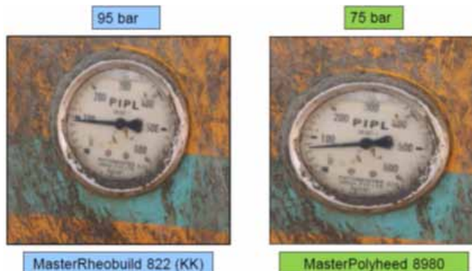
Obr. 5: Naměřené hodnoty tlaku čerpadla – vlevo s naftalensulfonátem, vpravo na bázi PAE
