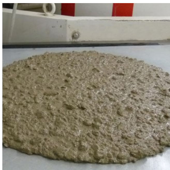
Beton mit tonhaltigen Sanden mit MasterSuna SBS
