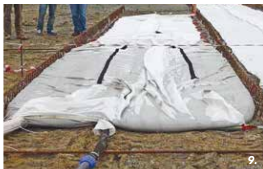
8, 9 e 10. Il campo prove per il riempimento di un saccone (con lunghezza di pompaggio di 550 m): la fase 1 (8), la fase 2 (9) e la fase 3 (10)
