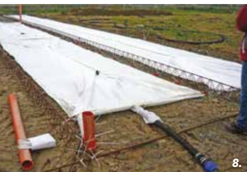
8, 9 e 10. Il campo prove per il riempimento di un saccone (con lunghezza di pompaggio di 550 m): la fase 1 (8), la fase 2 (9) e la fase 3 (10)
