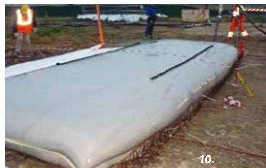
8, 9 e 10. Il campo prove per il riempimento di un saccone (con lunghezza di pompaggio di 550 m): la fase 1 (8), la fase 2 (9) e la fase 3 (10)
