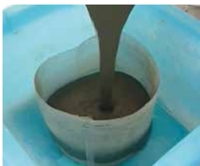
7. Un esempio di miscela cementizia con caratteristiche "antidilamento" a elevate prestazioni
