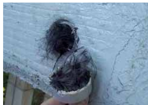
2.5 La prova di pull-out, l’impregnazione manuale non è corretta se il tessuto ha una grammatura elevata
