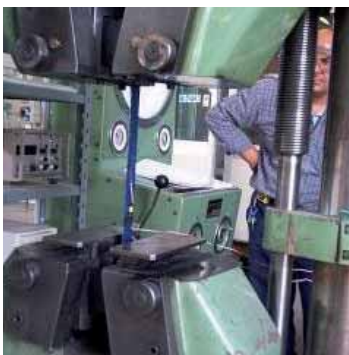
1.1 Prove di trazione su tessuto MasterBrace
