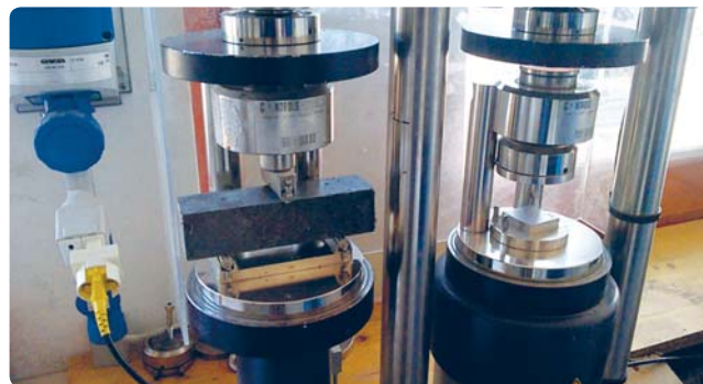
Esempio di test a flessione/trazione su MasterEmaco FR
