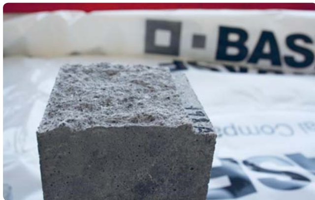
Un provino del nuovo MasterEmaco S499FR: fibre HPF diffuse nella matrice
