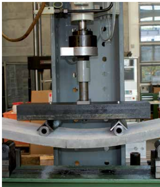
4-punkts böjhållfasthetstest i LMC laboratorium.
