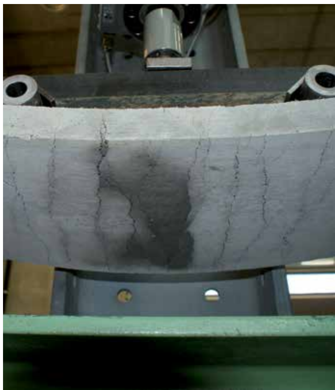
Multipel sprickbildning av betong armerad med MasterFiber.
