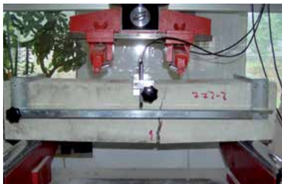
Utvärdering av C50-seghet vid olika fiberdoseringar
